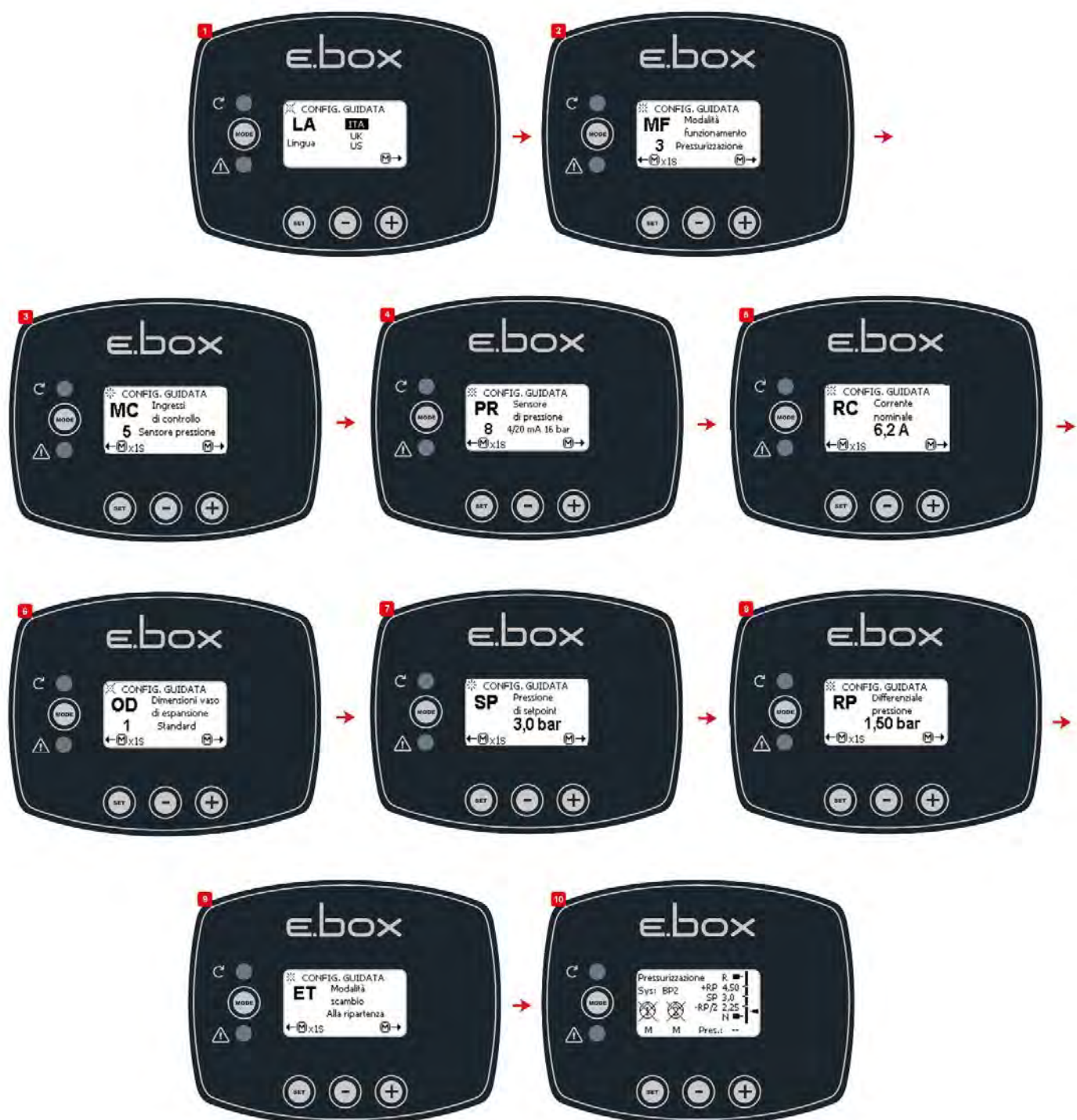
Схема 12: Конфигурация с датчиком давления
