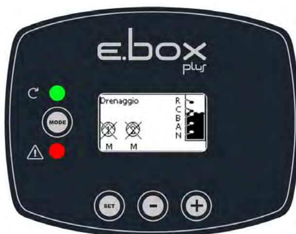
Схема 57: Этикетка клавиши и дисплей
