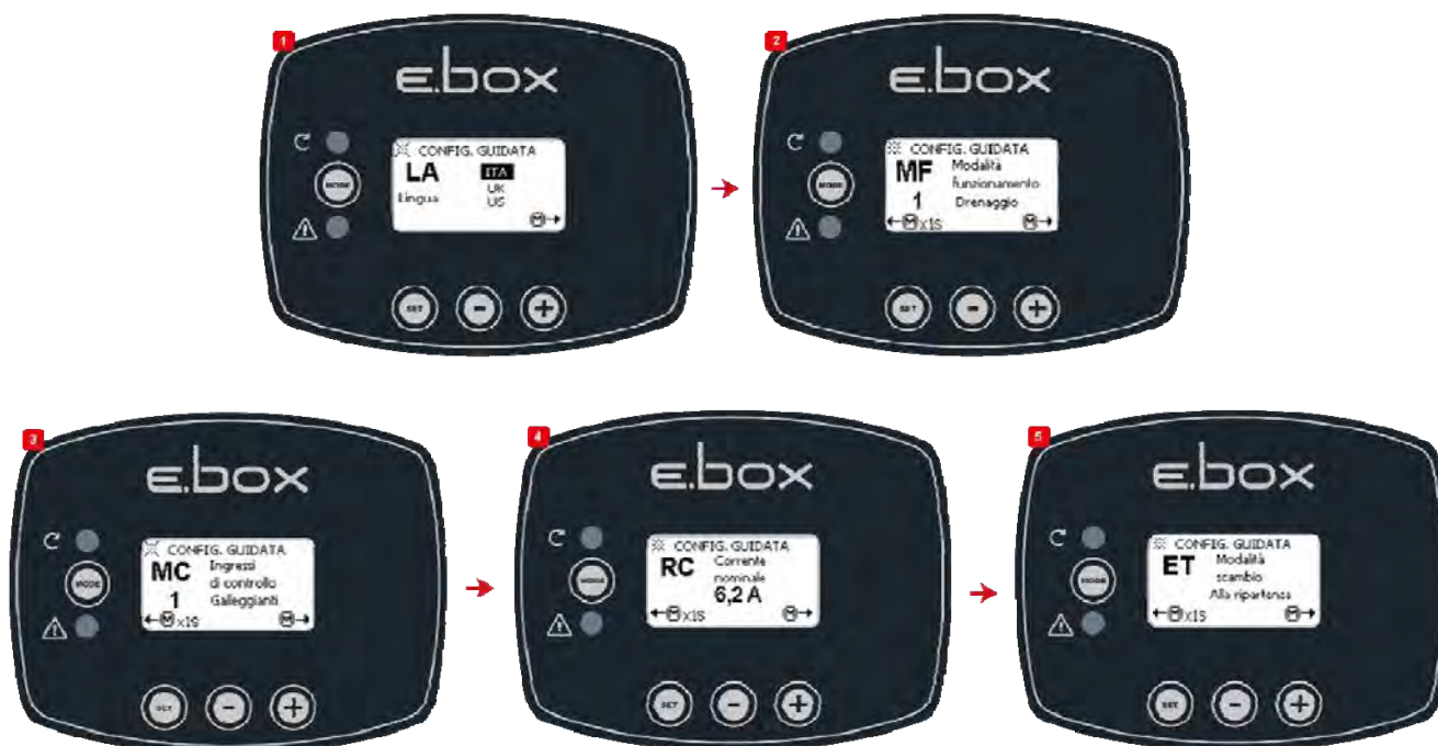
Схема 36: Конфигурация Дренажа поплавков или зондов уровня
