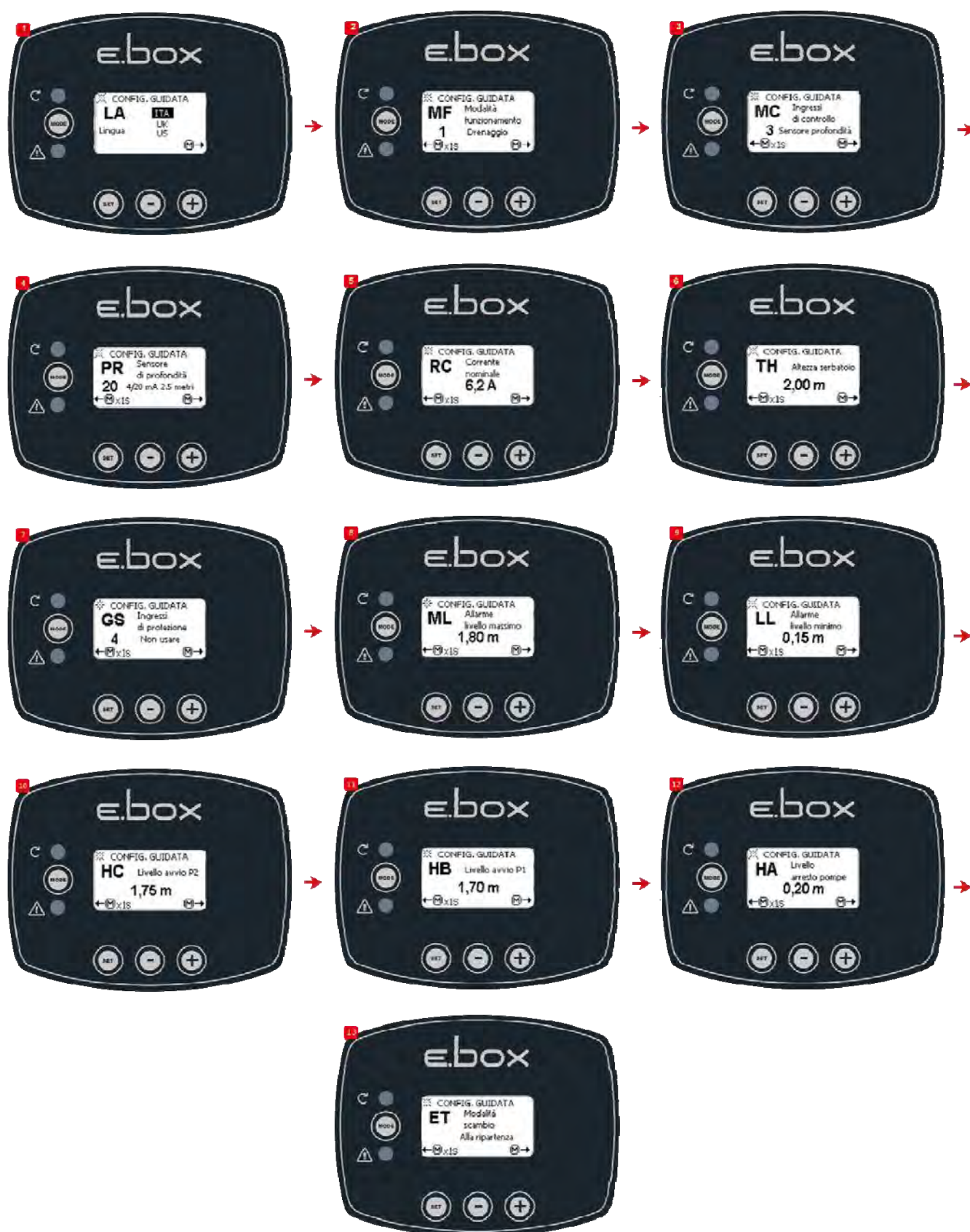
Схема 38: Конфигурация только с датчиком глубины
