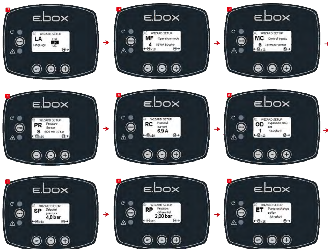
Схема 48: Подпор KIWA с датчиком давления
