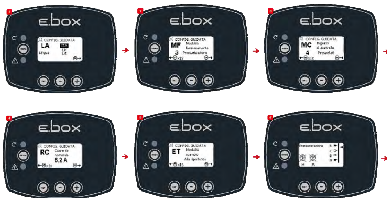
Схема 13: Конфигурация с реле давления
