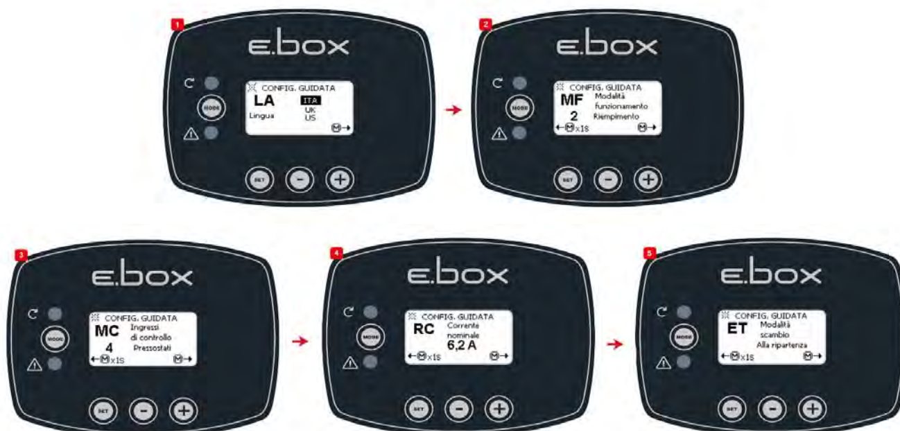
Схема 24: Конфигурация наполнения с поплавками или зондами уровня
