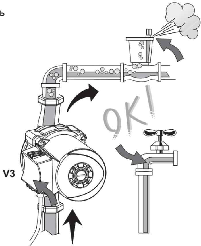
В трехфазных циркуляционных насосах, перед заполнением системы водой, всегда необходимо проверять направление вращения двигателя, вынув вантузную заглушку и включив двигатель на несколько секунд
