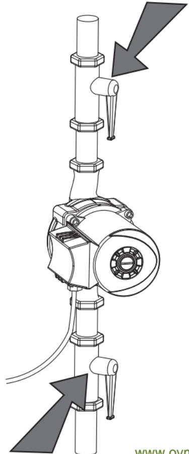
Вал двигателя циркуляционного насоса **ВСЕГДА** должен устанавливаться в горизонтальном положении, избегая попадания капель как на двигатель, так и на клеммную колодку.
