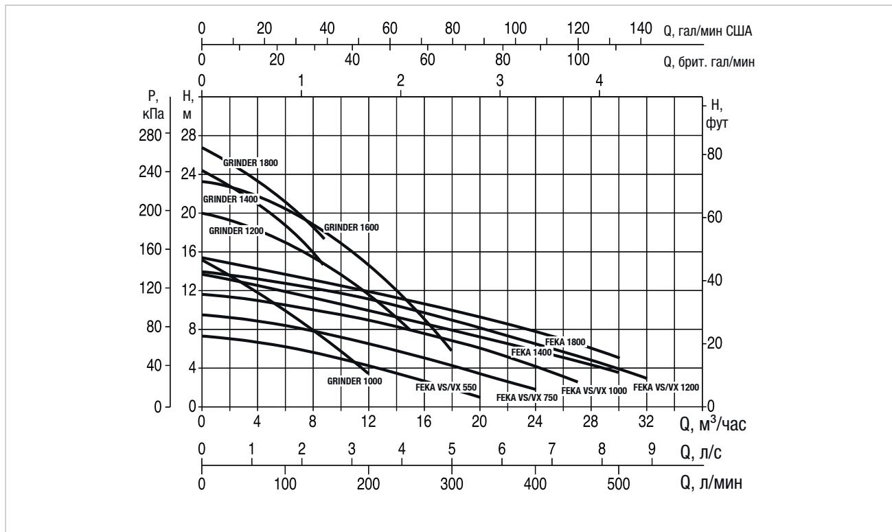
Кривые производительности рассчитываются на основе значений коэффициента кинематической вязкости = 1 мм<sup>2</sup>/сек и плотности = 1000 кг/м<sup>3</sup>. Погрешность кривых согласно ISO 9906.
